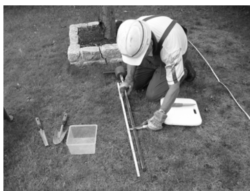
Abb. 2: Bodenprofil im Bohrstock
