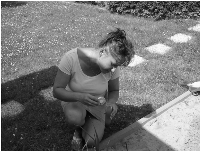
Abb. 6: Prüfung des pH-Wertes mit einem Indikator
