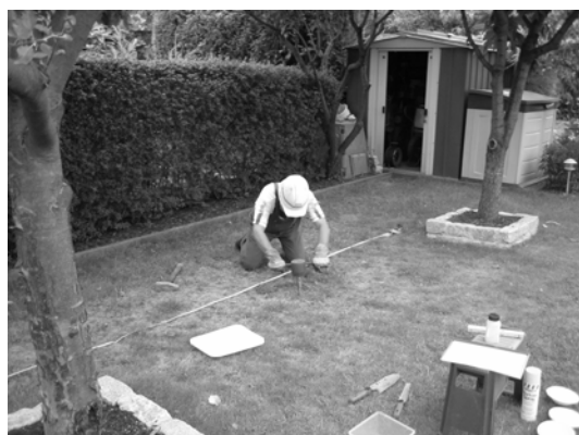
Abb. 1: Probenahme mit dem Bohrstock entsprechend Beprobungsraster
